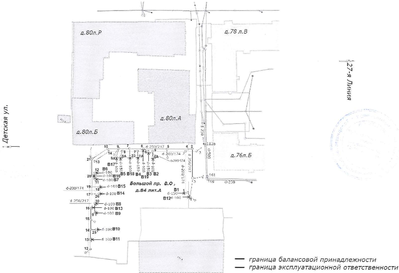
Граница эксплуатационной ответственности сторон устанавливается по линии раздела элементов систем канализации согласно схеме.
